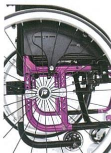
Telaio posteriore standard con molteplici possibilità di regolazione
