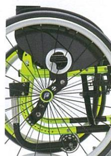
Telaio posteriore Dynamic (optional) con sistema multiregolazione ruota posteriore, schienale regolabile in inclinazione e spondina rotativa
